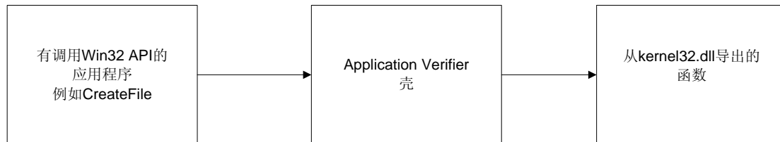
Application Verifier 产生一个“壳（shim）”截住从应用程序来的指令。在完成一定数量的测试或修改以后，shim 调用原先调用的窗函，然后在返回到调用窗函前，再有一次机会审查返回值。
