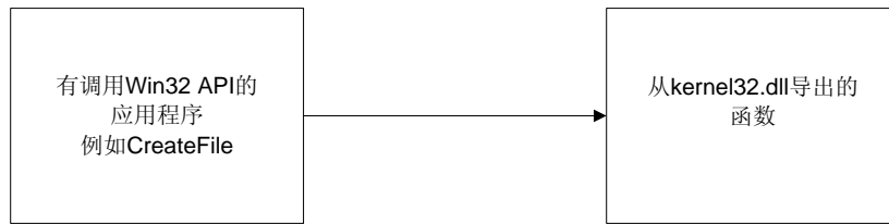
典型的应用程序使用Win32 API的方法。应用程序调用从视窗函数库导出的函数
